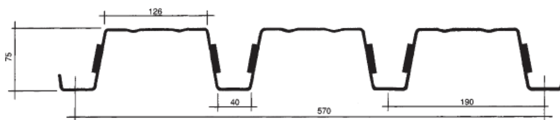
CARATTERISTICHE STATICHE DELLA LAMIERA
